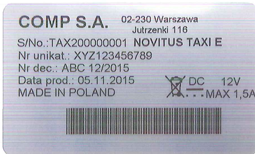
Rys. 4. Tabliczka znamionowa taksometru
